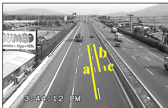
Σχήμα 5.9. Οι τρεις αποστάσεις a, b, c που χρησιμοποιήθηκαν ως γνωστές για ανεξάρτητους υπολογισμούς της ταχύτητας οχημάτων.
