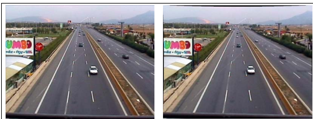
Σχήμα 5.12. Αριστερά: αρχική εικόνα. Δεξιά: εικόνα διορθωμένη από ακτινική διαστροφή.
