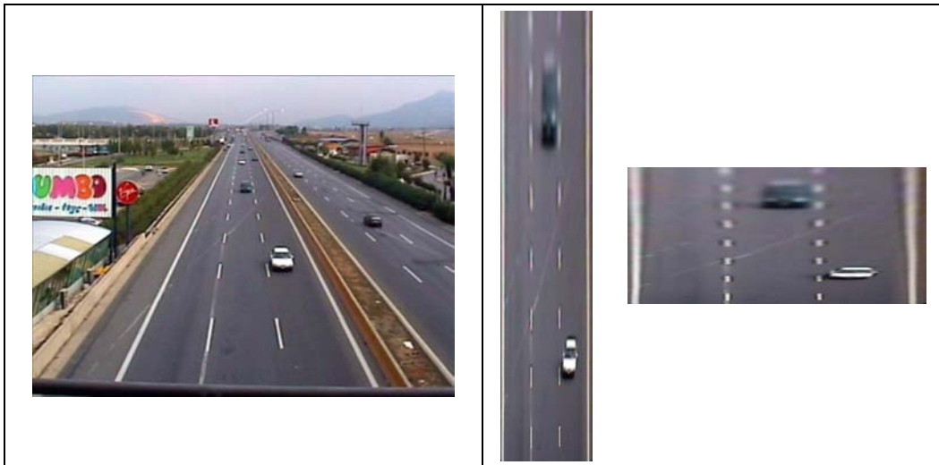
Σχήμα 5.3. Αρχική μετωπική εικόνα και δύο αφινικές αναγωγές της με διαφορετικούς συντελεστές σχετικής κλίμακας στους δύο κάθετους άξονες του δρόμου.
