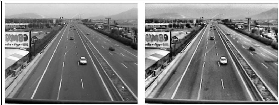
Σχήμα 5.13: Αριστερά: αρχική εικόνα. Δεξιά: εικόνα μετά από εφαρμογή δυναμικής ισοστάθμισης ιστογράμματος και φίλτρου εξομάλυνσης Wiener.
