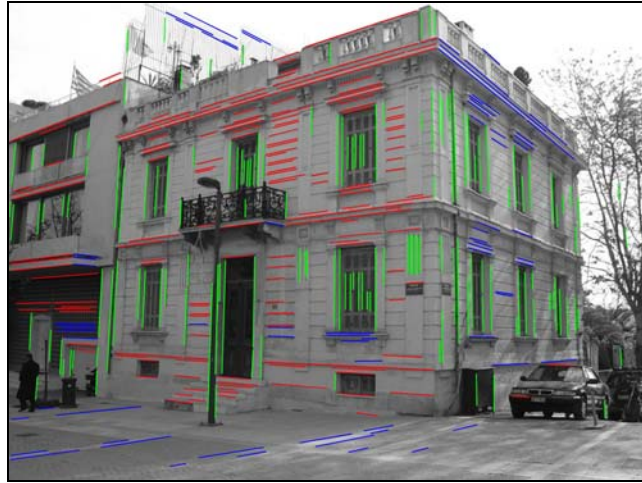
Σχήμα 1.4. Αυτόματη ομαδοποίηση ακμών κατά τις τρεις κύριες διευθύνσεις του χώρου.
