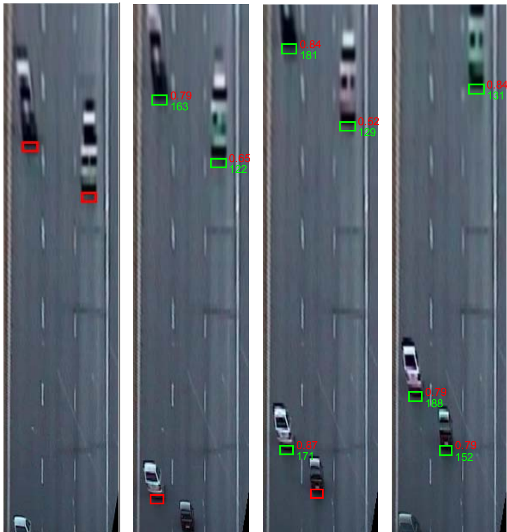
Σχήμα 5.18. Ανίχνευση των προφίλ των οχημάτων σε τρεις διαδοχικές ανηγμένες εικόνες μέσω του συντελεστή συσχέτισης.
