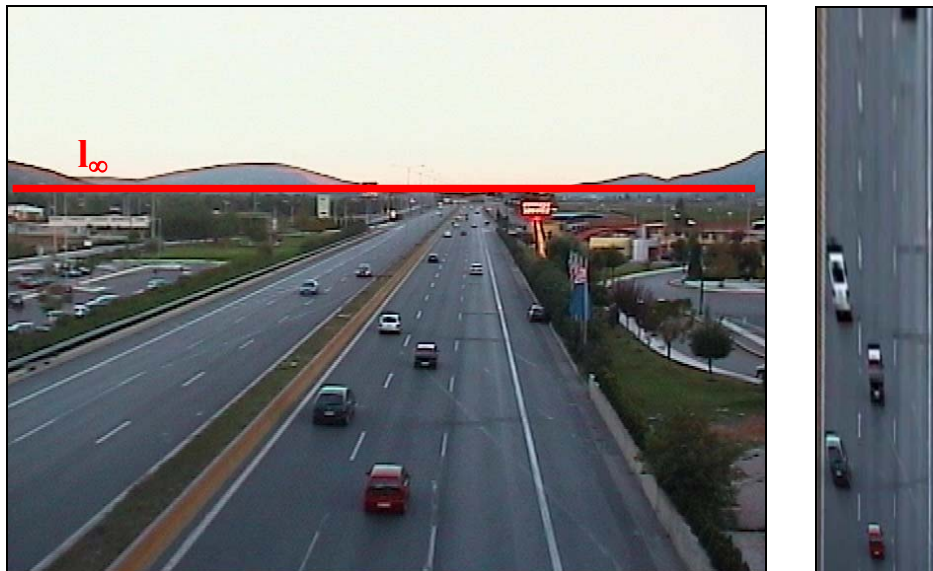
Σχήμα 5.4. Αριστερά: πλάγια εικόνα με οριζόντια ευθεία φυγής I_\infty . Δεξιά: αφινικά ανηγμένη εικόνα βάσει της ομογραφίας H .
