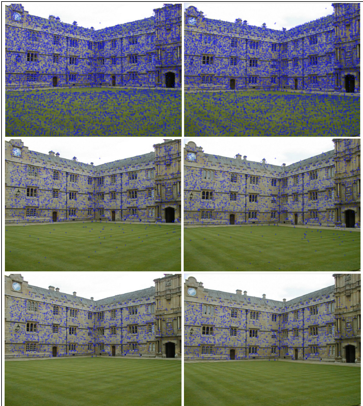
Σχήμα Α.1. Αυτόματη μέτρηση ομόλογων σημείων ( 1^\circ στερεοζεύγος). Εξαγωγή σημείων SIFT (πάνω), εύρεση ομολογιών μεταξύ των σημείων SIFT μέσω σύγκρισης των διανυσμάτων τους (μέσον), τελικές ομολογίες σημείων SIFT μετά από την εφαρμογή του αλγορίθμου RANSAC (κάτω).
