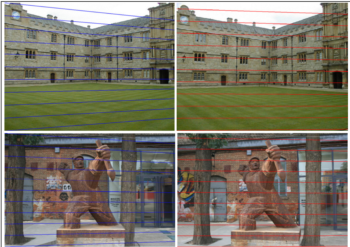
Σχήμα 6.6. Παράδειγμα ομόλογων επιπολικών ευθειών ( 1^\circ και 8^\circ στερεοζεύγος).
