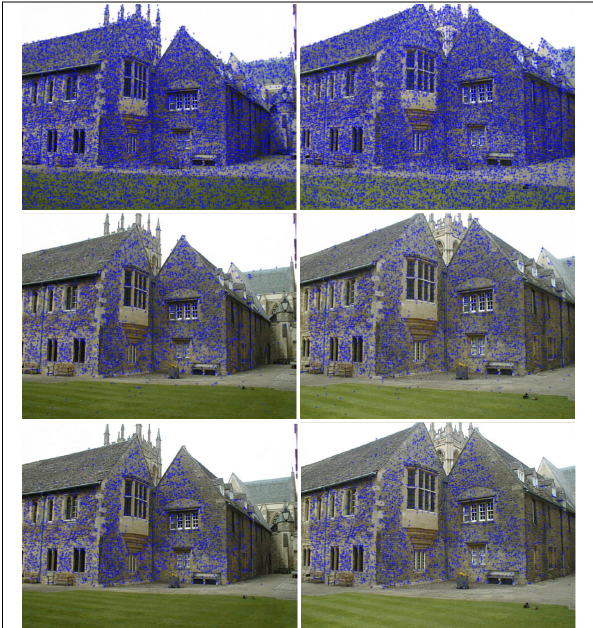
Σχήμα 6.4. Αυτόματη μέτρηση ομόλογων σημείων (2 ο στερεοζεύγος). Εξαγωγή σημείων SIFT (πάνω), εύρεση ομολογιών μεταξύ των σημείων SIFT μέσω σύγκρισης των διανυσμάτων τους (μέσον), τελικές ομολογίες σημείων SIFT μετά από την εφαρμογή του αλγορίθμου RANSAC (κάτω).
