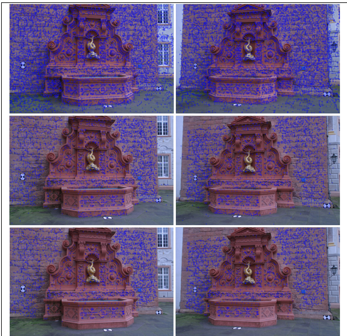
Σχήμα 6.5. Αυτόματη μέτρηση ομόλογων σημείων (3 ο στερεοζεύγος). Εξαγωγή σημείων SIFT (πάνω), εύρεση ομολογιών μεταξύ των σημείων SIFT μέσω σύγκρισης των διανυσμάτων τους (μέσον), τελικές ομολογίες σημείων SIFT μετά από την εφαρμογή του αλγορίθμου RANSAC (κάτω).
