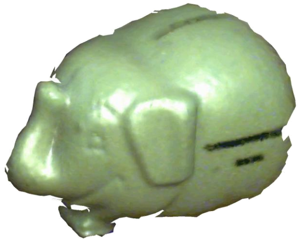
Εικόνα 6.5: Το συνενωμένο νέφος σημείων με φωτοϋφή: α) μετά από τον μετασχηματισμό βάσει αρχικών τιμών και β) μετά από την εφαρμογή του αλγορίθμου ICP.
