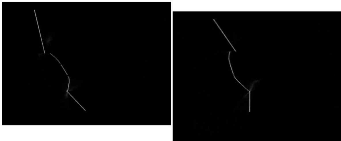
Εικόνα 3.7: Επιπολικό ζεύγος της τομής του επιπέδου του laser με την επιφάνεια του αντικειμένου.
