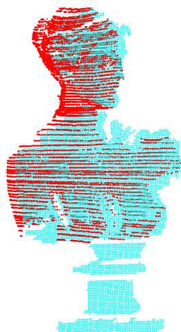
Εικόνα 6.12: Νέφη για την σύγκριση μέσω εφαρμογής του ICP. Με κυανό το νέφος από τον SL2 Scanner και με κόκκινο το νέφος από τον σαρωτή της διατριβής.
