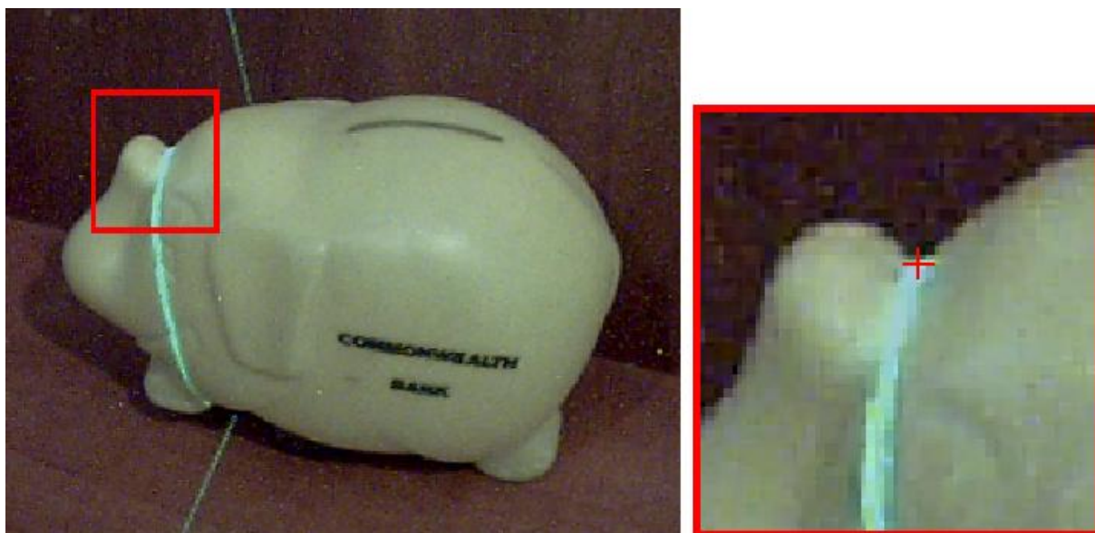
Εικόνα 4.9: Λεπτομέρεια εικόνας: στο σημείο που υποδεικνύεται το σφάλμα στον προσδιορισμό της θέσης του μεγίστου της καμπύλης Gauss είναι \sigma_b = \pm 0.542 pixel. Το σημείο αυτό απορρίπτεται λόγω του μεγέθους του σφάλματος προσδιορισμού της θέσης του.
