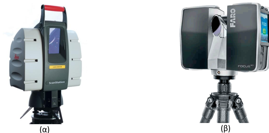
Εικόνα 1.3: α) Σαρωτής τύπου παλμού (πηγή: ιστοσελίδα Leica – βλ. βιβλιογραφία). β) Σαρωτής τύπου διαφοράς φάσης φέροντος κύματος (πηγή: ιστοσελίδα FARO – βλ. βιβλιογραφία).
