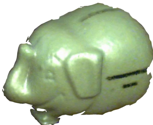
Εικόνα 5.8: Τα συνενωμένα νέφη σημείων, μετά από τριγωνισμό, με φωτοϋφή (βλ. ενότητα 5.6).
