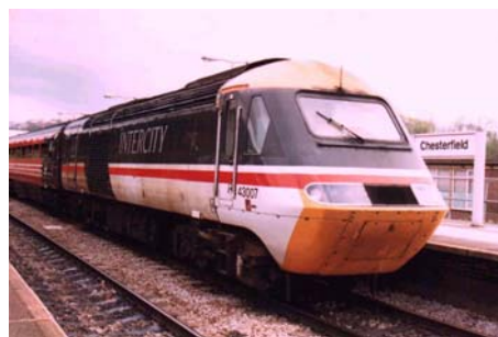
Η Βρετανική ντηζελοκίνητη πολλαπλή μονάδα Intercity Sparrow (ρεκόρ ταχύτητας ντηζελοκίνητης έλξης 235 χλμ/ώρα)
