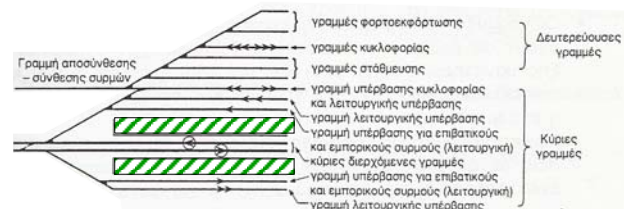
Κύριες και δευτερεύουσες γραμμές ενός ενδιάμεσου σταθμού ταθ-
